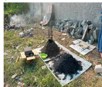
Gambar . Tahapan pembuatan arang briket dari sekam padi.
